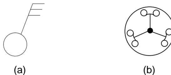
Gambar 4. Sakelar kutub tiga (a) Simbul dan (b) Konstruksi
