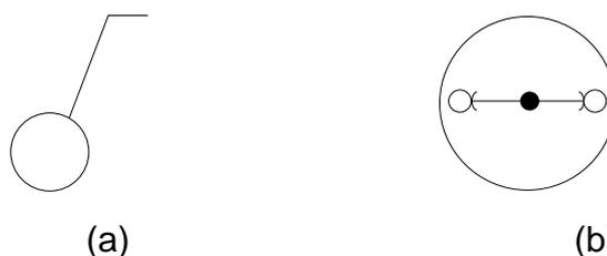
Gambar 2. Sakelar tunggal (a) Simbul dan (b) Konstruksi
