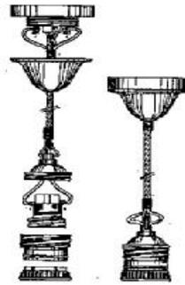
Gambar 21. Konstruksi Fitting gantung
