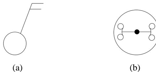
Gambar 3. Sakelar kutub ganda (a) Simbul dan (b) Konstruksi
