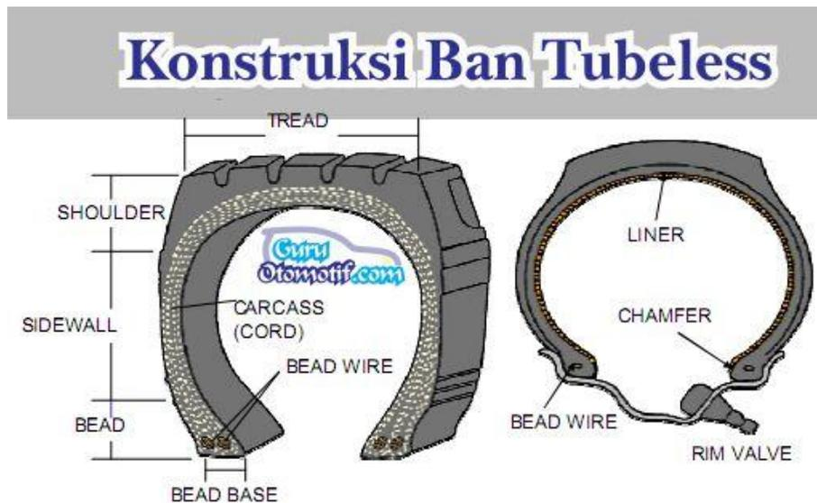
Gambar 2.2 Konstruksi Ban Tubeless
