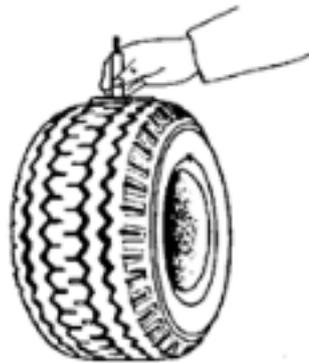
Gambar 3.8 Pengukuran Keausan Ban
