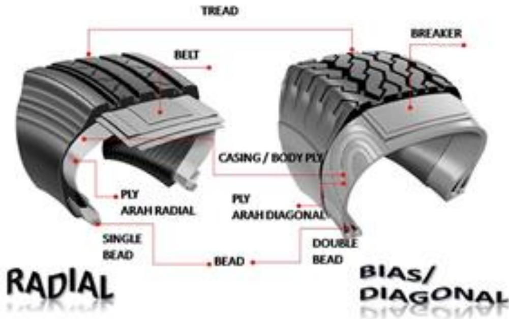
Gambar 2.7 Perbandingan Konstruksi Ban
