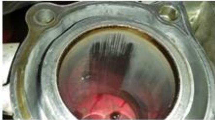
Gambar 4.2. Kerusakan dinding pada blok silinder
