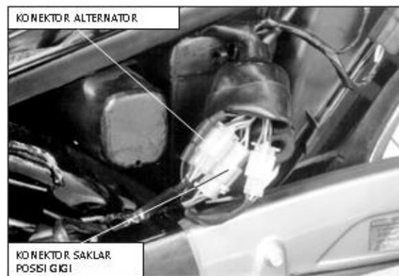
Gambar 1.4. Konektor Alternator
