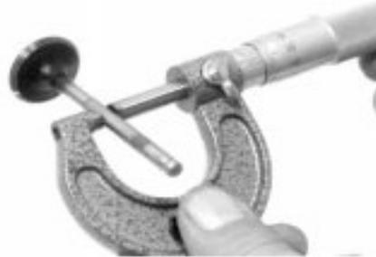
Gambar 3.15. Pengukuran keausan batang katup
