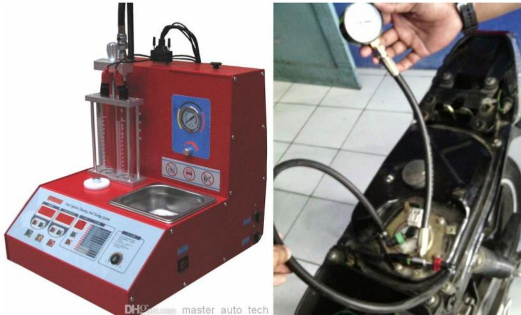
Gambar 2.30. Menguji injektor dengan injektor cleaner dan menguji pompa bensin dengan manometer
