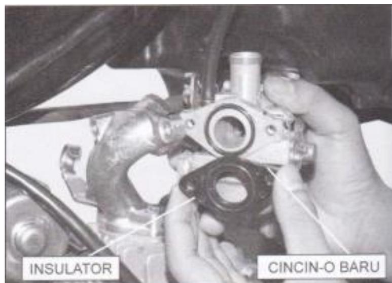
2) Pasang insulator dan karburator ke manifold kencangkan baut-baut dengan baik.
