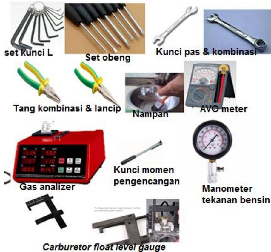
Gambar 2.26. Peralatan yang digunakan perbaikan sistem bahan bakar bensin
