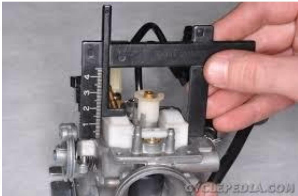
Gambar 2.29. Pemeriksaan ketinggian pelampung dengan *Carburetor float level gauge*
