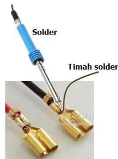
Gambar 37. Penyolderan sepatu kabel
