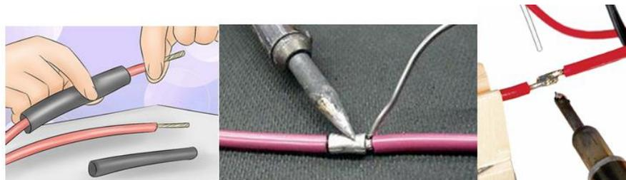
Gambar 33. Menyambung kabel
