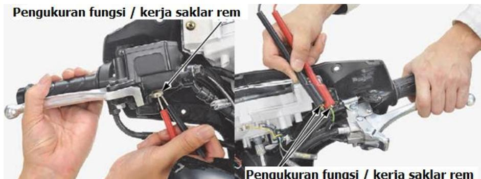
Gambar 16. Pengukuran fungsi/kerja saklar rem depan dan belakang
