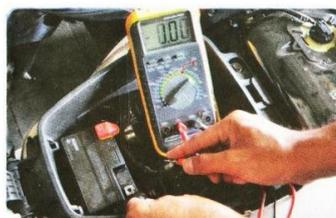
Ukur kebocoran arus dilakukan secara seri antara kutub negati baterai dengan klem terminal kabel negatif
