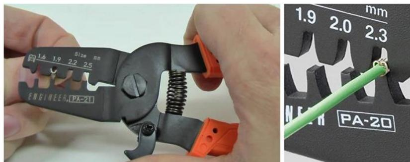
Gambar 40. Cara penggunaan tang pengepres sepatu kabel
