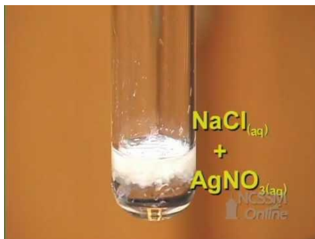
Gambar 4 Pembentukan Endapan \text{AgCl}
