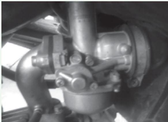
Gambar 49. Posisi sekrup udara dan penahan skep (throttle piston) pada karburator yang terdapat pada salah satu merk sepeda motor (Sumber gambar: koleksi pribadi)
