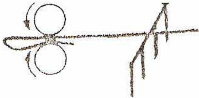
Gambar 116. Arah penyusunan serat pada mesin combing
