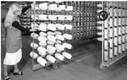
Gambar 12. Bentuk dan skema creel
