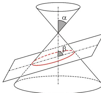
Gambar 96. Irisan kerucut dan bidang berupa ellips
