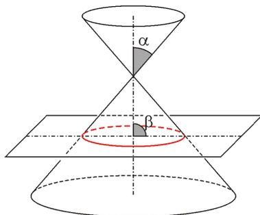
Gambar 95. Irisan kerucut dan bidang berupa lingkaran
