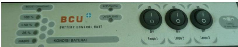
Ada tiga buah saklar yang masing-masing untuk Lampu 1, lampu 2, dan lampu 3.
