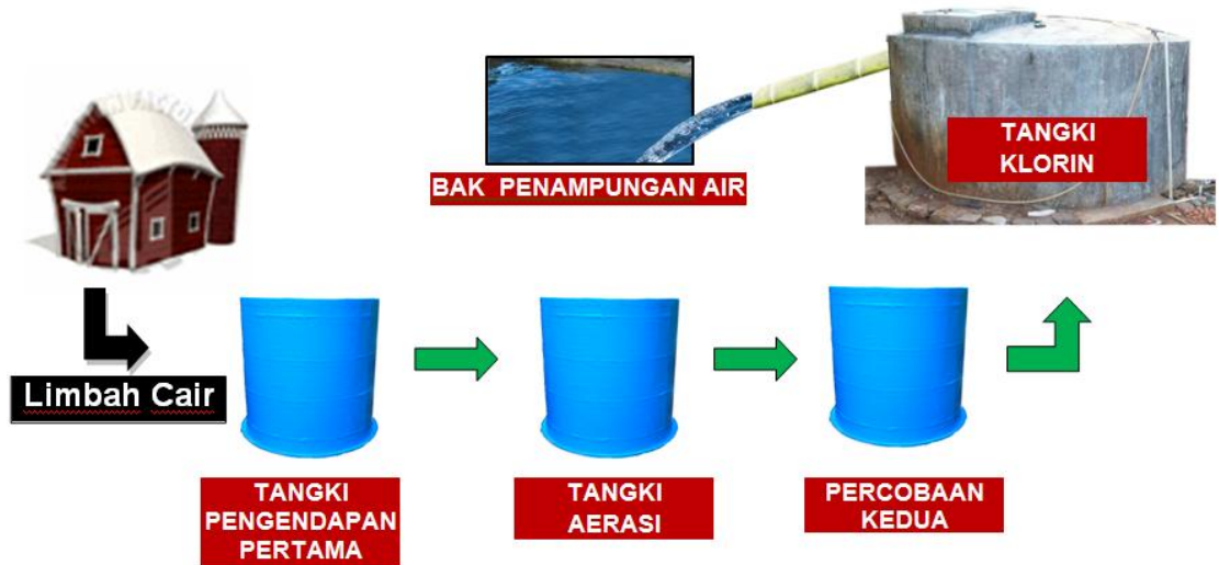
Gambar 1. Skema Percobaan Pengolahan Limbah Cair
