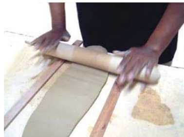
Gambar 2-6. Proses Pengujian Susut Kering Tanah Liat
