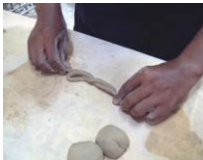
Gambar 2-4. Proses Pengujian Plastisitas Tanah Liat.
