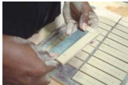
Gambar 2-7. Proses Pengujian Susut Kering Tanah Liat
