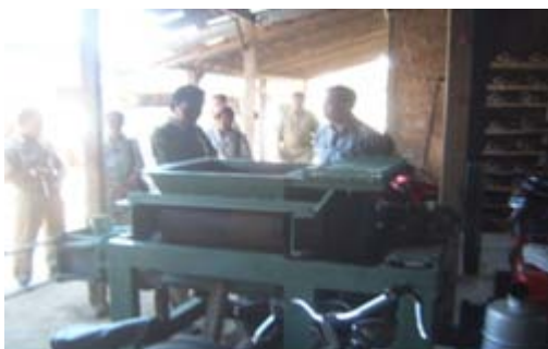
Gambar 1-1. Alat pengolahan tanah liat dengan tenaga mesin (masinal)
