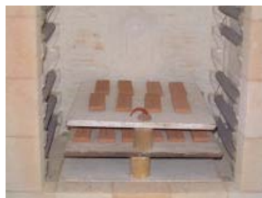
Gambar 2-9. Proses pembakaran benda uji
