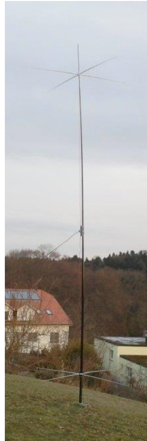
Gambar 8.13. Rancangan antenna dan bentuk jadi antenna bekerja di 40m band
