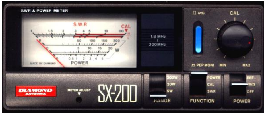
Gambar 7.24. Panel depan sebuah Power / SWR meter merk Diamond
