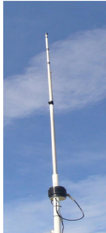
Gambar 8.12. Rancangan antena dan bentuk jadi antena bekerja di 6m band
