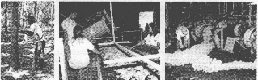
Gambar II, (8-10): Pengolahan karet dari getah menjadi bahan baku
