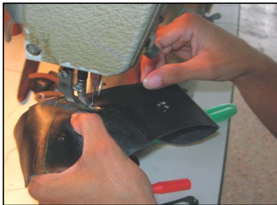
Gambar 3.49. Menjahit bagian counter
