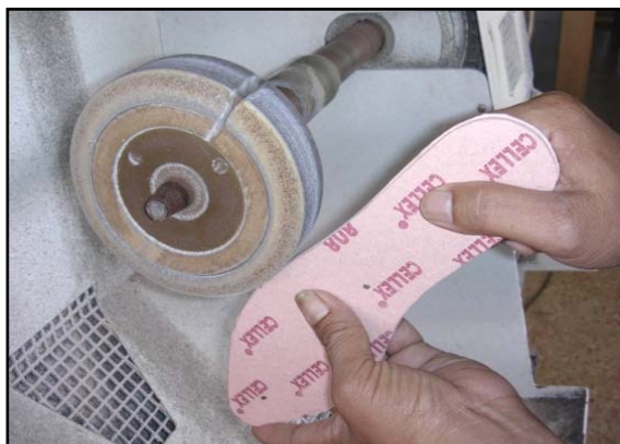
Gambar 3.60. Menghaluskan potongan in sole
