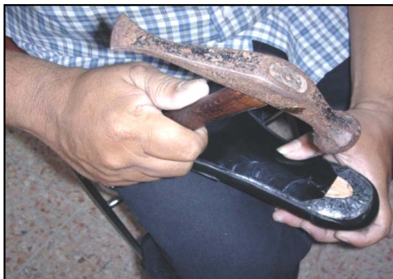
Gambar 3.84. Perataan sole luar dengan pukul
