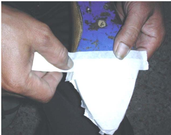
Gambar 3.56. Pemolaan telapak acuan dengan paper tape
