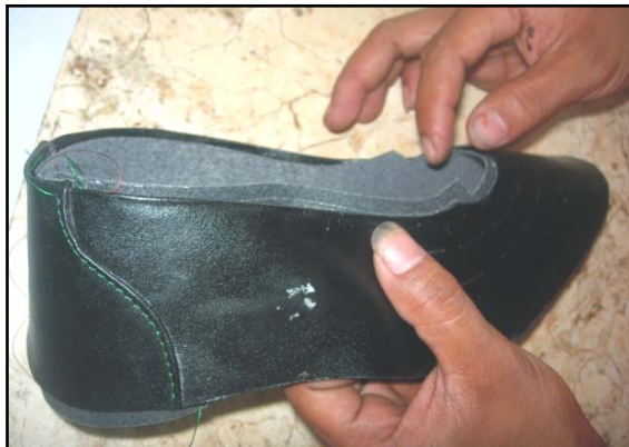
Gambar 3.52. Pemasangan lapis dalam
