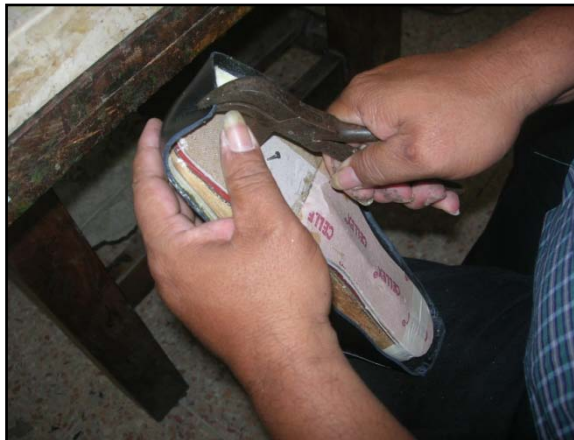
Gambar 5.59. Menarik pada bagian ujung
