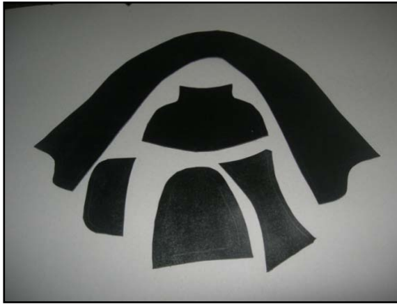
Gambar 5.40. Hasil penyesetan komponen bagian
