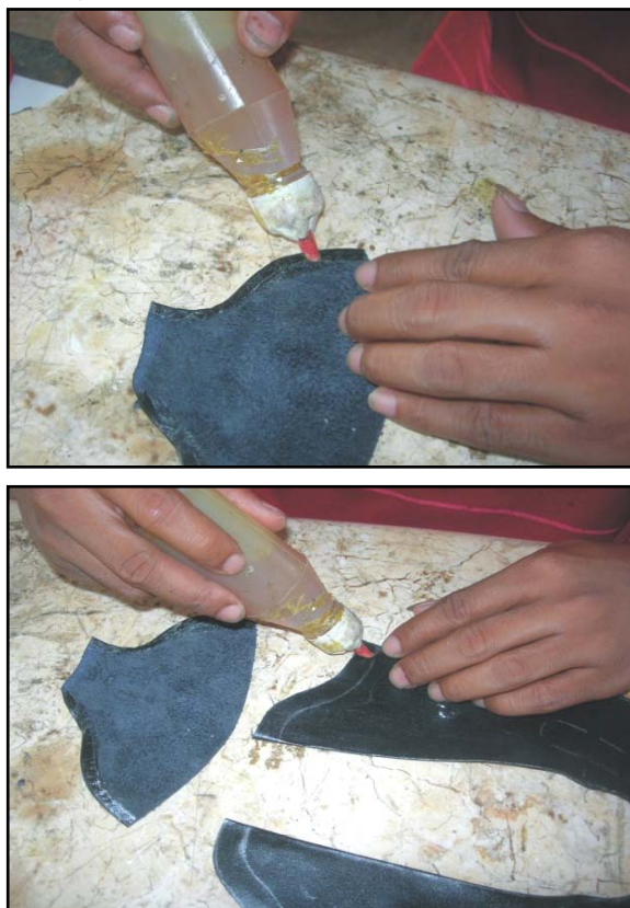
Gambar 3.47. Memberi lem pada bagian back counter dan vamp
