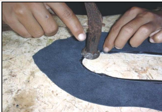
Gambar 3.46. Melipat kulit dengan bantuan pukul besi
