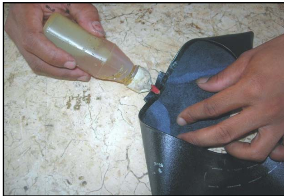
Gambar 3.48. Merakit back counter dengan vamp
