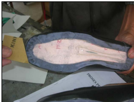
Gambar 5.65. Pengasaran permukaan in sole
