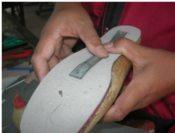
Gambar 3.68. Posisi penempelan tamsin pada telapak
