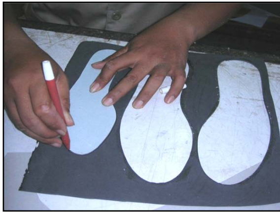
Gambar 3.58. Memolakan pada kertas in sole
