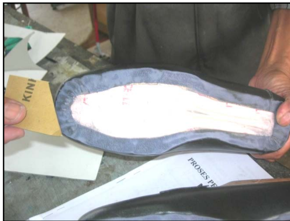
Gambar 3.76. Meratakan bagian openan
