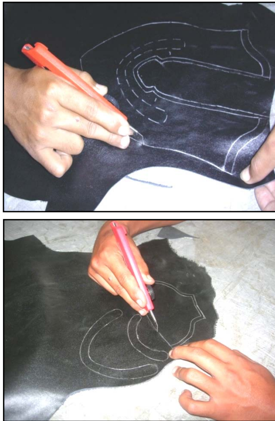
Gambar 3.40. Langkah pemotongan kulit dengan pisau
