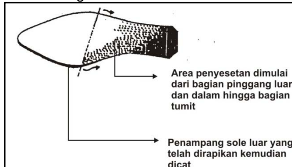
Gambar 3.80. Posisi pengerjaan sole luar
