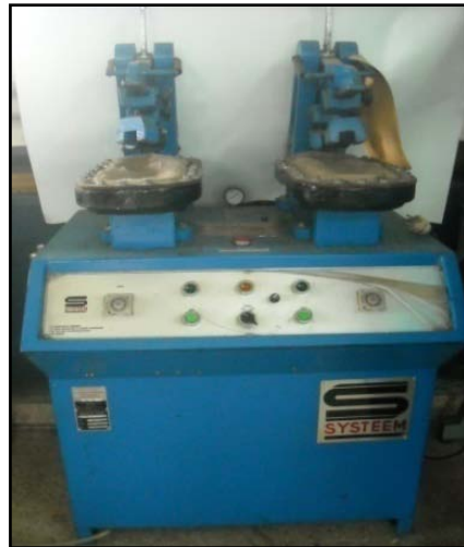
Gambar 3.21. Mesin press sepatu Sumber: Dokumen Studio Kulit P4TKSB Yogyakarta
