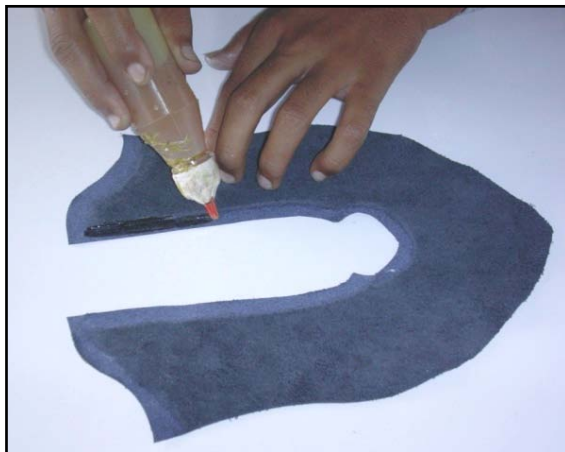
Gambar 3.42. Mengelem bagian lipatan
