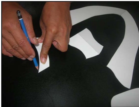
Gambar 5.37. Memola pada bahan kulit
