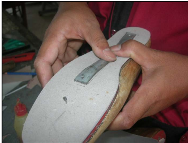
Gambar 5.49. Memasang in sole pada acuan
