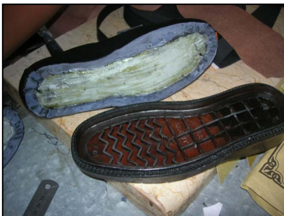
Gambar 5.66. Pengeleman telapak acuan
