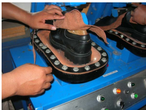
Gambar 5.68. Pengepresan dengan kulit
