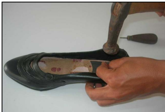
Gambar 3.88. Memaku hak sepatu
