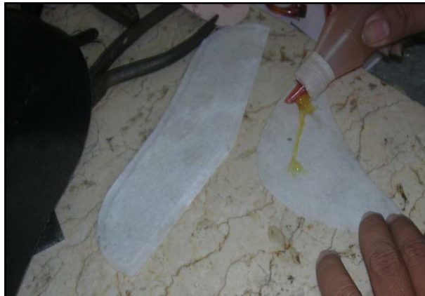
Gambar 5.57. Memberi lem pada pengeras
