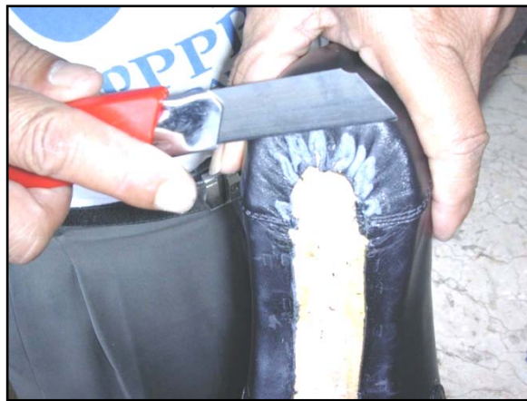
Gambar 3.73. Meratakan bagian openan
