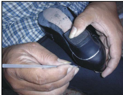
Gambar 3.81. Pemberian tanda untuk hak
