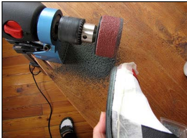
Gambar 5.50. Menghaluskan bagian in sole
