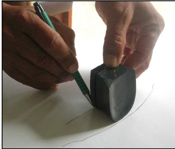
Gambar 3.77. Membuat pola lapisan hak dengan cara diputar
