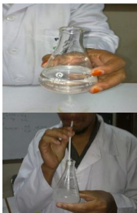
Gambar 7. Perubahan air kapur setelah ditiup
