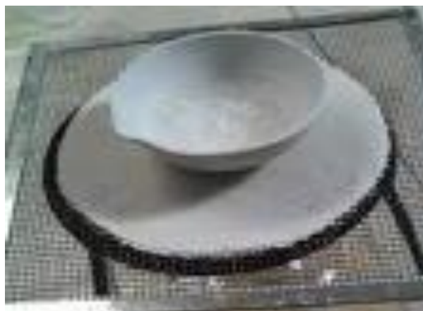
Gambar 14. Teknik Kristalisasi melalui penguapan
