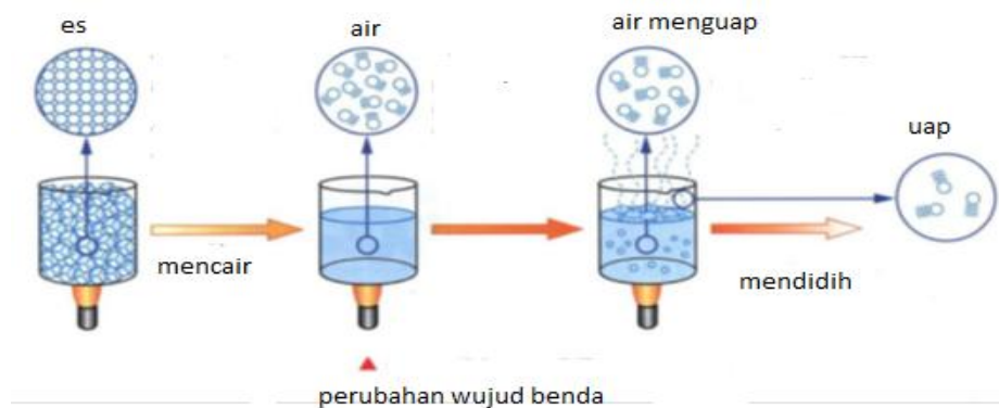
Gambar 2. Perubahan struktur partikel pada wujud benda (air)
