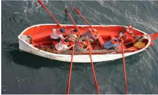
Gambar 57. Sekoci penolong mekanik dengan dayung sebagai tenaga penggerak
