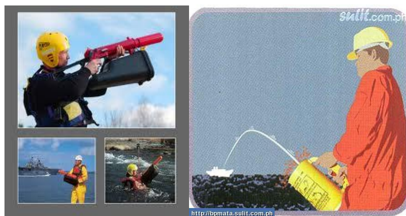
Gambar 89. Line throwing appliances digunakan untuk meluncurkan tali
