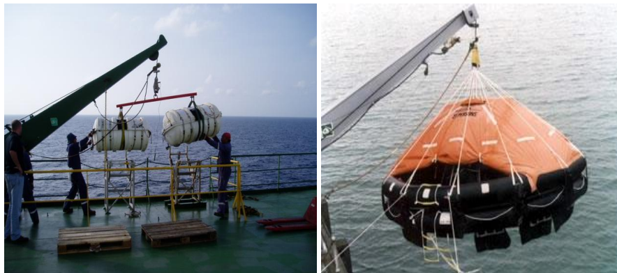
Gambar 68. Jenis rakit penolong yang diturunkan menggunakan davit
