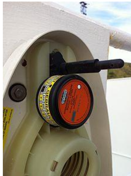
Gambar 92. Hydrostatic Release System pada EPIRB
