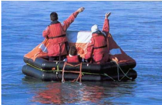
Gambar 67. Rakit penolong setelah dikembangkan di laut
