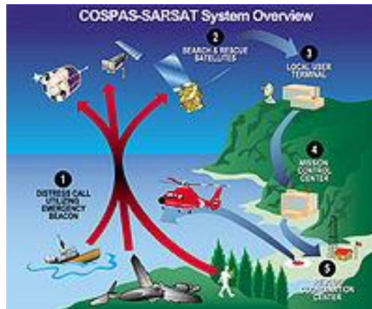
Gambar 91. Sistem kerja EPIRB
