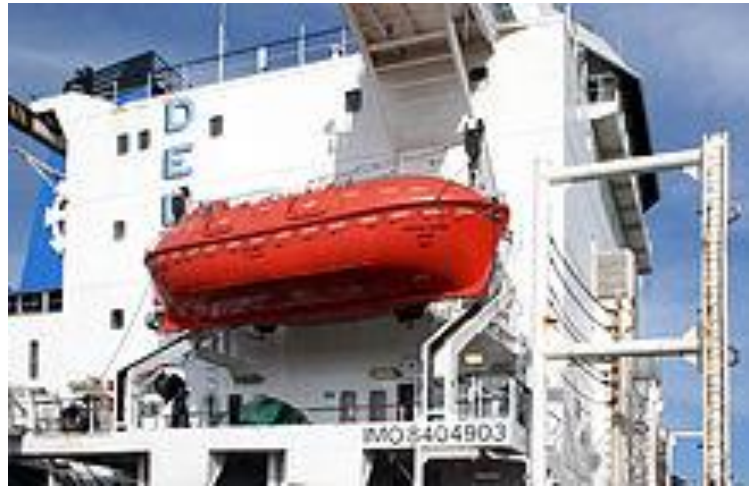
Gambar 62. Penempatan sekoci di kapal
