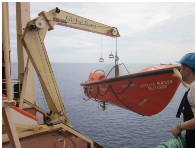
Gambar 28. Proses penurunan sekoci penyelamat menggunakan dewi-dewi untuk menolong orang yang jatuh ke laut
