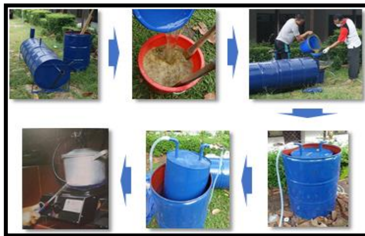
Gambar 16. Alur proses pembuatan gasbio
