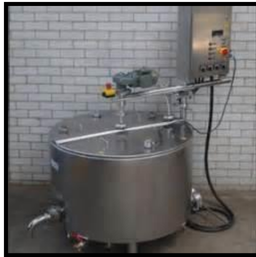
Gambar 25. Alat pasteurisasi skala industry
