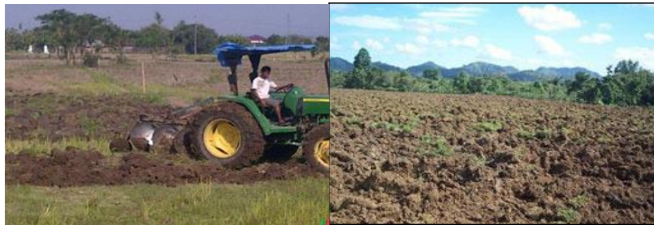
Gambar 2.2 Membajak dan hasil pembajakan dengan traktor
