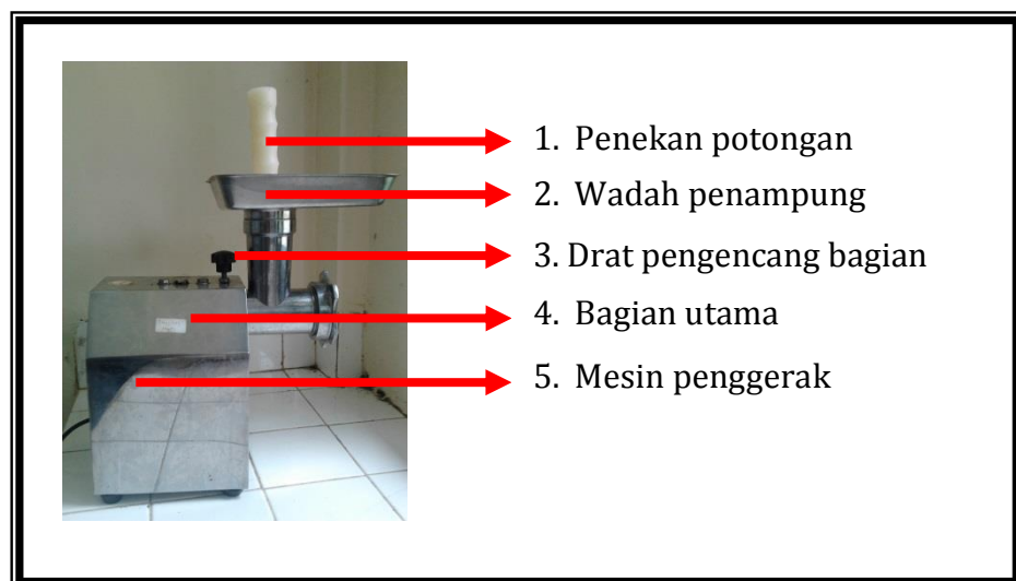
Gambar 57. bagian-bagian mesin penggiling daging
