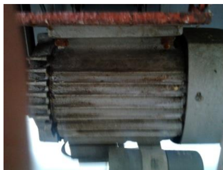
Gambar 60. motor penggerak pada mesin pencampur adonan
