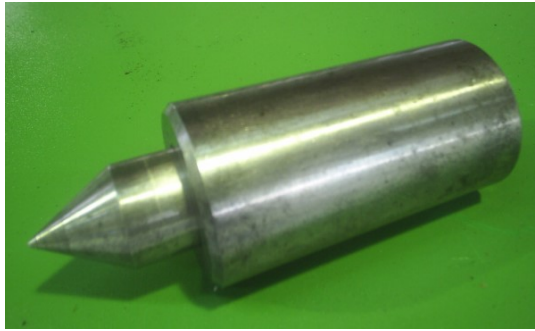
Gambar 2.30 Center Mati diikat pada Housing
