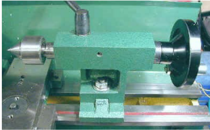
gambar 2.28 Pemasangan Center Putar
