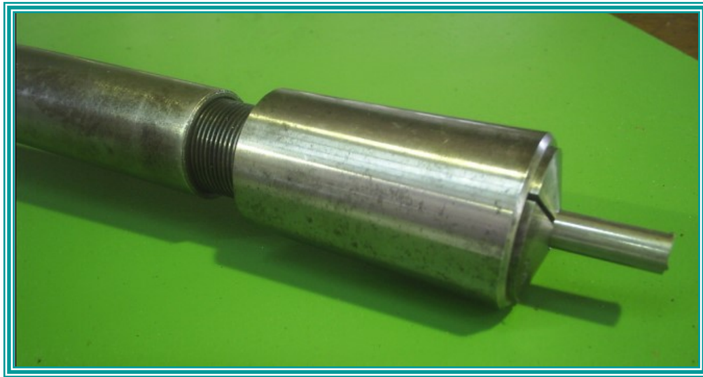
Gambar 2.37 Pengikatan benda kerja dengan collet
