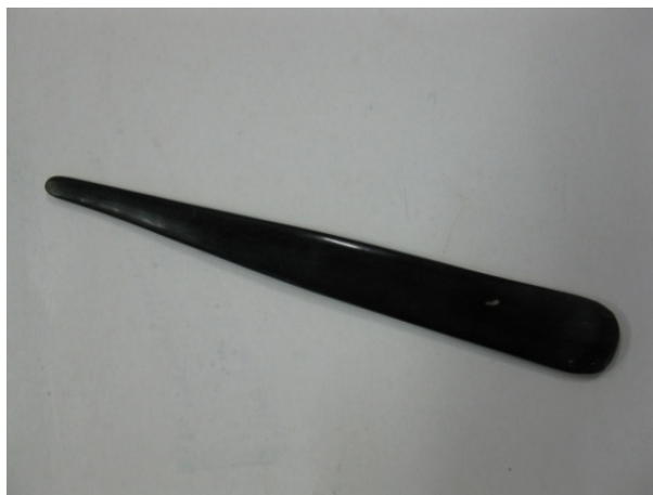
Gambar 17. Penekan plat sudut-sudut sempit agar cekung /cembung Sumber; Dokumen studio logam, 2012
