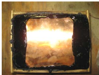
Gambar 47. Penempelan plat logam pada jabung Sumber; Dokumen studio logam, 2013
