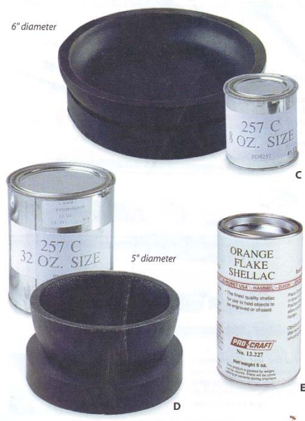
Gambar 22. Bahan landasan ukir logam dan tempatnya buatan luar negeri
