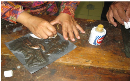
Gambar 41. Mengkilapkan benda kerja dengan cara digosok kain braso
