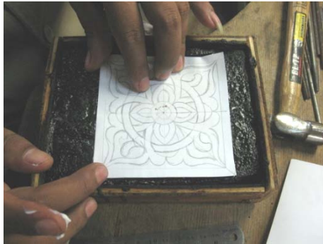
Gambar 48. Pola ditempel di atas logam Sumber; Dokumen studio logam, 2013
