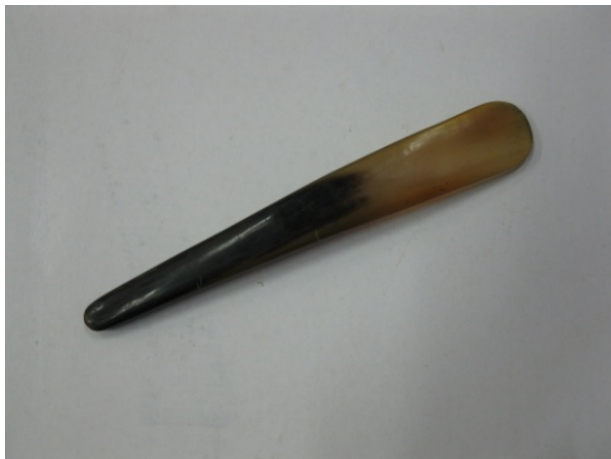
Gambar 15. Penekan plat ujung lebar agar cekung /cembung Sumber; Dokumen studio logam, 2012
