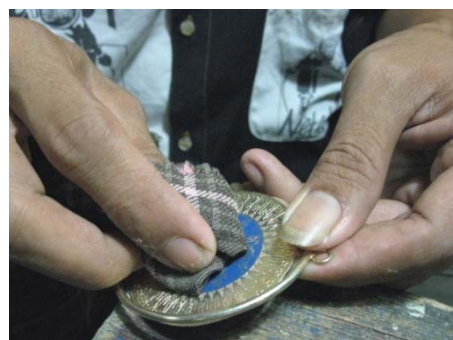
Gambar 69. Menggosok agar mengkilap Sumber; Dokumen studio logam, 2013
