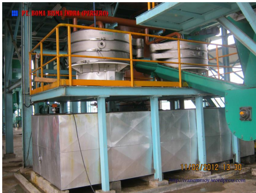
Gambar 96. Crude Oil Tank sebagai tempat penampungan sementara ( ivanemmoy.wordpress.com )
