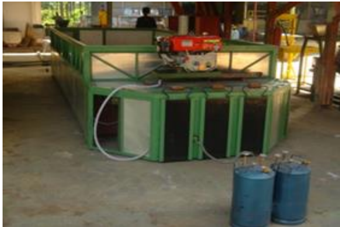
Gambar 36. Alat pengering kakao (iccri.net)
