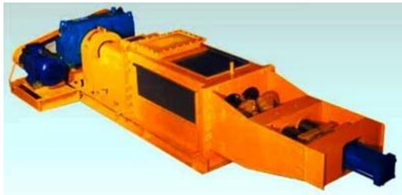
Gambar 94. Alat pressing digunakan untuk memperoleh minyak kasar ( intisawit.blogspot.com )
