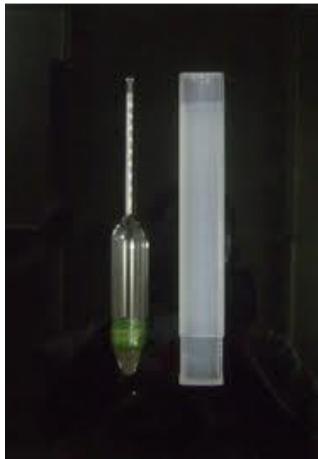
Gambar 63. metrolac untuk mengukur kadar karet kering (fotoperkebunan.blogspot.com)
